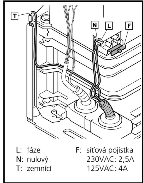
☞ Komponenty A.T., A.P., SG.C, SG.A a STOP se musí nacházet bez proudu, aby nedošlo ke škodám na provozním panelu.
