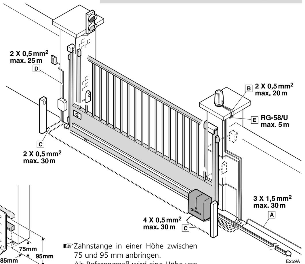
☞ Zahnstange in einer Höhe zwischen 75 und 95 mm anbringen. Als Referenzmaß wird eine Höhe von 90 mm empfohlen.
