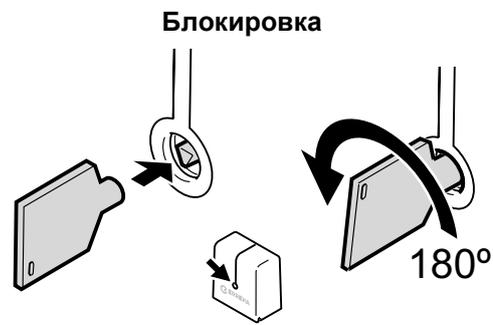
**Блокировка для механического привода:**
