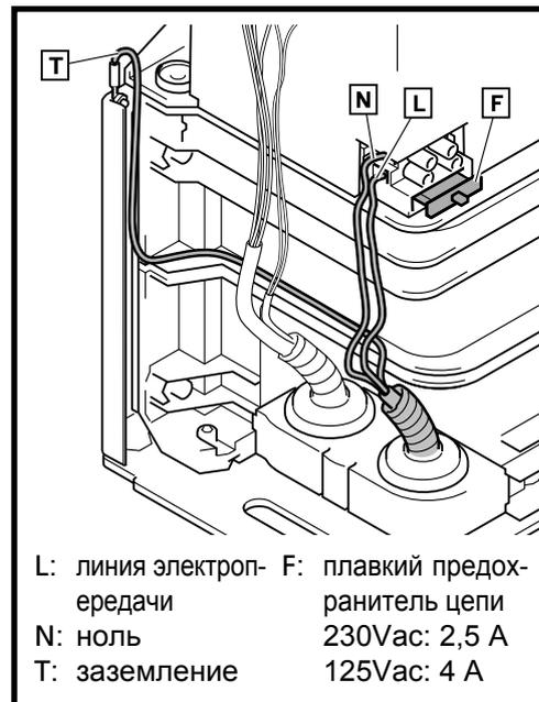
⚠ Устройства A.T., A.P. с устройств SG.C, SG.A и STOP необходимо снимать напряжение, чтобы не повредить панель управления.
